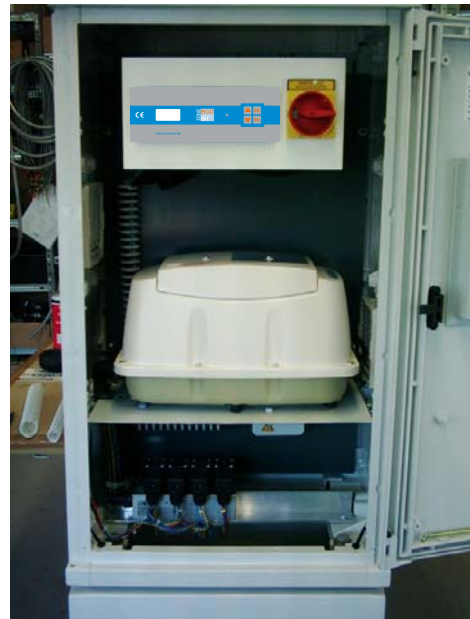
Abbildung 2 Innenansicht mit Steuerung, Verdichter und Ventilanschlüssen
